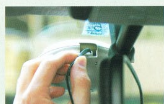
▲本体がしっかり固定されたことを確認したら、次は電源ケーブルを本体につなぐ。ミラーがじゃままで差しにくい場合は、先の細い工具で。
