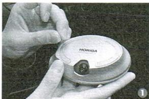
本体の裏側に付属のテープをはがして、フロントガラスの内側に貼り付ける。テープは衝撃でも外れないように、強力な粘着力があるので、事前に貼る場所を決めておく。
